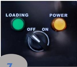
El panel de control del compresor es muy sencillo (fig 7). Incorpora un piloto verde que indica cuando el compresor esta en proceso de carga y un piloto naranja que indica si el compresor está conectado.
