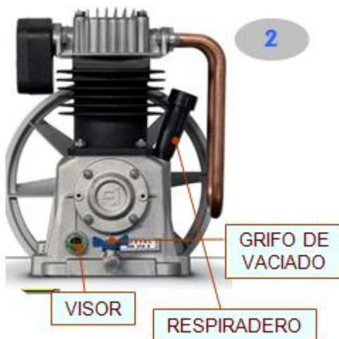
Esta parte del compresor es la cabeza compresora que genera aire comprimido, bombeando aire e introduciéndolo en el depósito a través del tubo de impulsión. El mecanismo interno del cabezal es lubricado por borboteo con aceite especial Josval.
