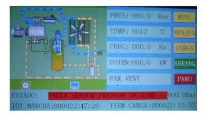
6) Protección por disfunción del ventilador VSD: Si el ventilador de velocidad variable falla, el controlador detendrá el compresor.
