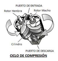
La compresión continúa hasta que los lóbulos empujan el aire hacia el puerto de descarga. El aire comprimido entonces es descargado hacia el depósito separador aire/aceite. Hay cinco ciclos de compresión completos por cada rotación completa del rotor macho.
